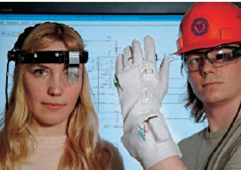
Studenten der Uni Bremen demonstrieren zwei Ausführungen der „head mounted displays“ und einen elektronischen Handschuh mit Bewegungssensoren.
