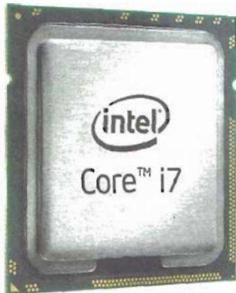
**Intel Core i7**, „der schnellste Prozessor aller Zeiten“, braucht 1366 Pins, ein älterer Pentium der ersten Baureihe kam mit 478 aus. Nun jedoch: Aufrüstung ade. „Lynnfield“, der für später im Jahr 2009 angekündigte Prozessor, mag noch mehr haben. Der i7 hat vier Rechenwerke (Rechenkerne), die software-gesteuert jeweils zwei unabhängige Programmfolgen (Threads) bearbeiten. (ff.)
